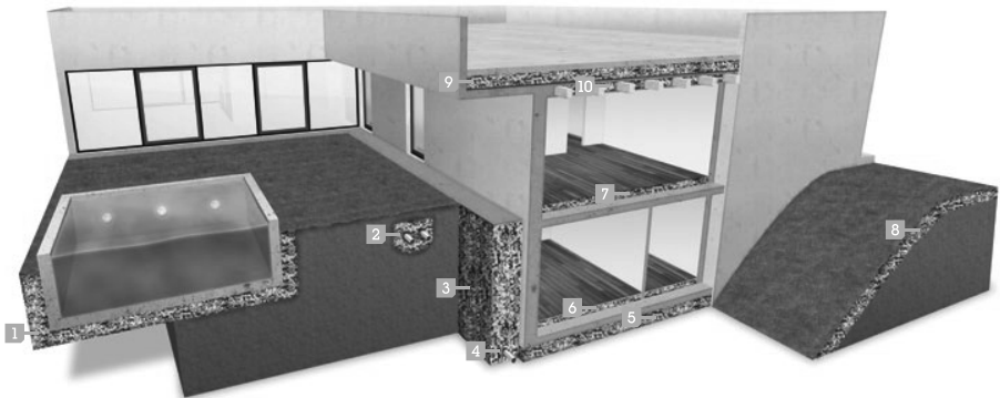
Lastabtragende Dämmung unter der Bodenplatte
