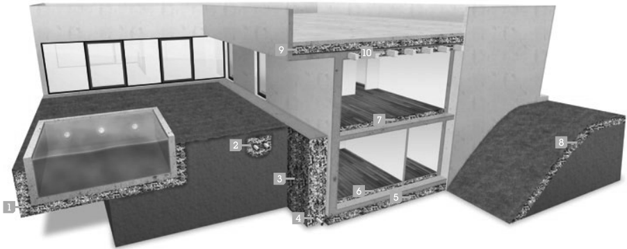
Lastabtragende Dämmung unter der Bodenplatte
