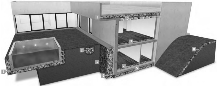
Lastabtragende Dämmung unter der Bodenplatte
