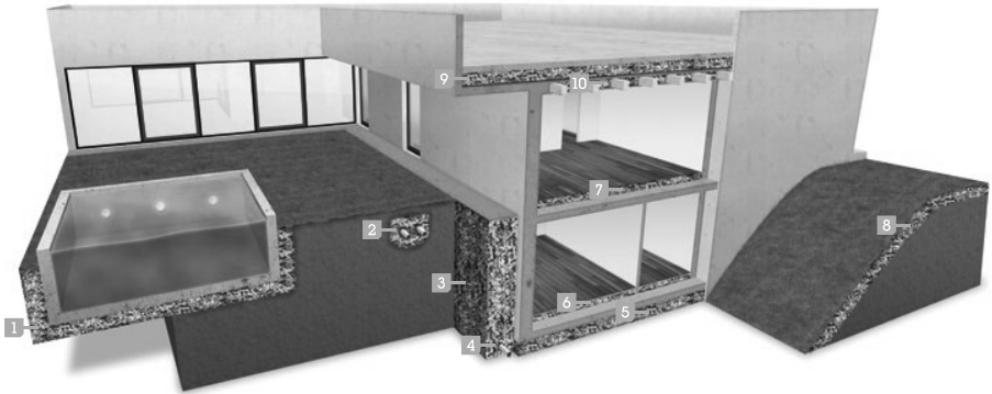
Lastabtragende Dämmung unter der Bodenplatte
