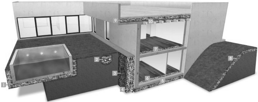
Lastabtragende Dämmung unter der Bodenplatte
